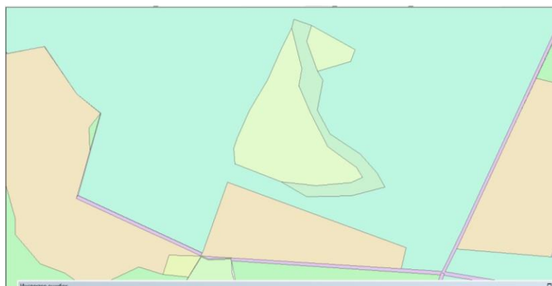
Рис. 33. Отображение после исправления ошибки с накладкой полигонов
